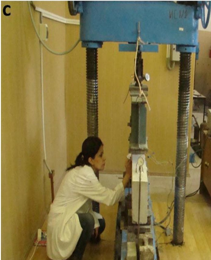
الشكل (2-17) اختبار الجوائز وتسجيل النتائج ، a- وضع الجائز على جهاز الاختبار وتجهيزه بأدوات القياس المختلفة، b- اختبار الجائز وتسجيل مختلف النتائج ، c- تحديد التشققات عند كل مستوى تحميل، d- تصوير العينات بعد الانتهاء من اختبارها.
