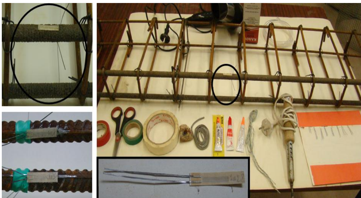
الشكل (10-2) عملية لصق حساسات التشوه على قضبان التسليح والأدوات والمواد المستخدمة لتوصيلها وعزلها.
