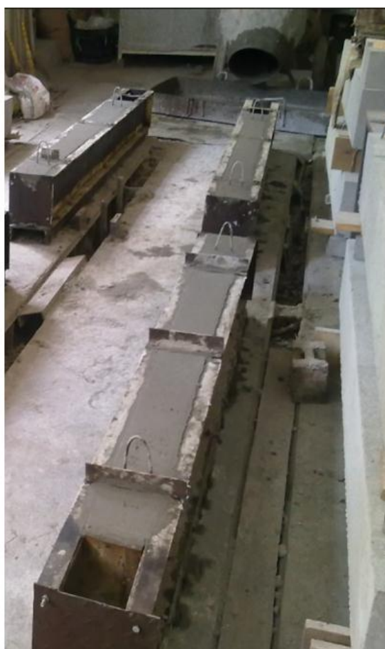
الشكل (2-4) شكل القوالب الفولاذية بعد الانتهاء من عملية صب الجوائز البيتونية، حيث تم صب 3 جوائز متماثلة بالتسليح وبالأبعاد الهندسية من بيتون كل مجموعة، بالإضافة لـ 3 مكعبات بيتونية بأبعاد (15*15*15 سم).
