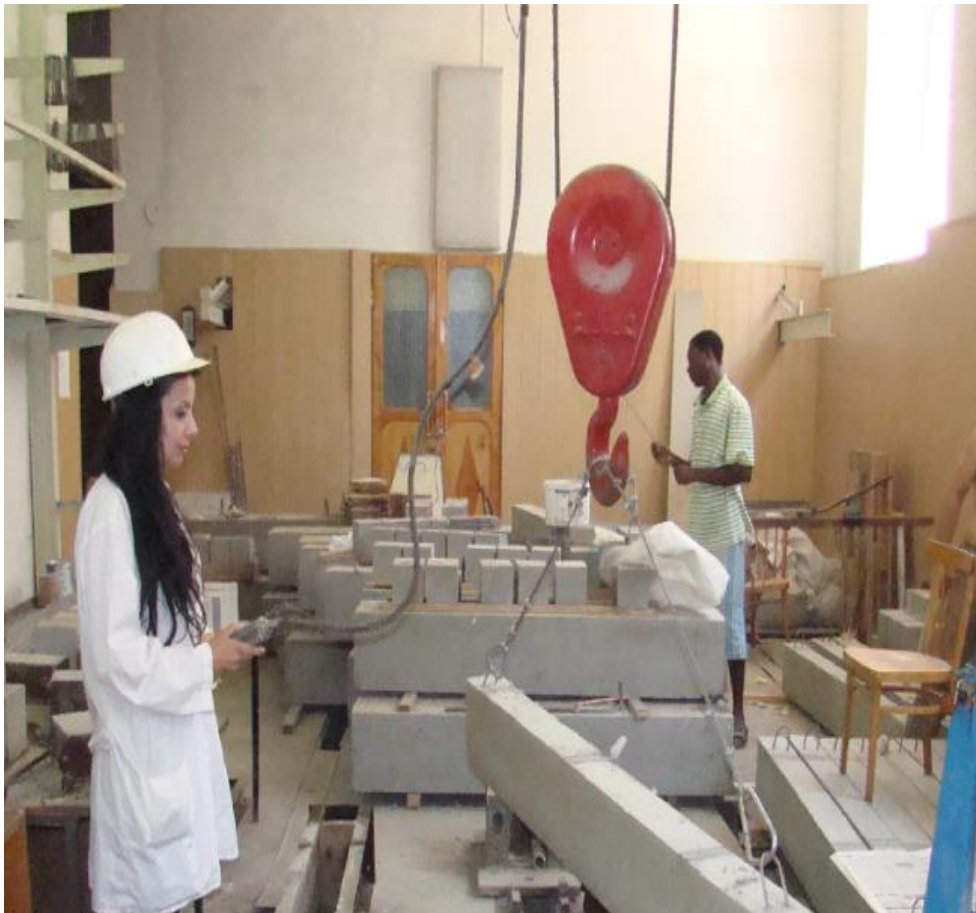
الشكل (2-13) عملية إخراج ونقل العينات من القوالب المعدنية بعد تصلب البيتون باستخدام رافعة مخبرية.
