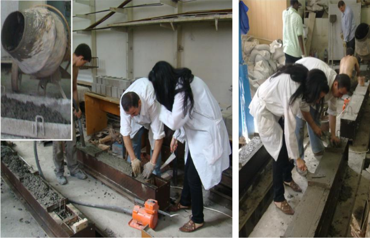
الشكل (2-12) عملية جيل البيتون بالجبالة الكهربائية، وصب الجوائز البيتونية في القوالب المعدنية، واستخدام الرجاجة الابرية لرج البيتون.
