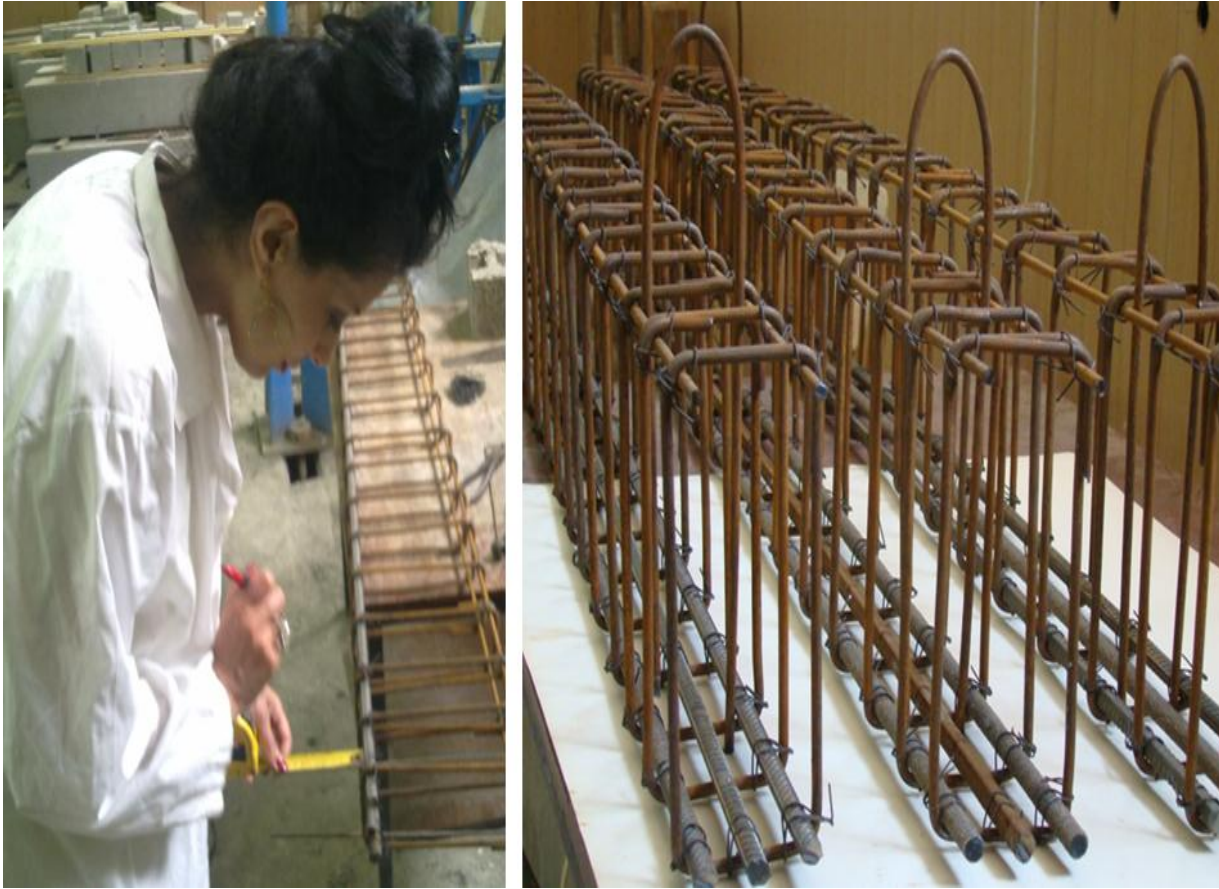
الشكل (2-9) عملية تحضير هياكل التسليح لكل مجموعة جوائز .
