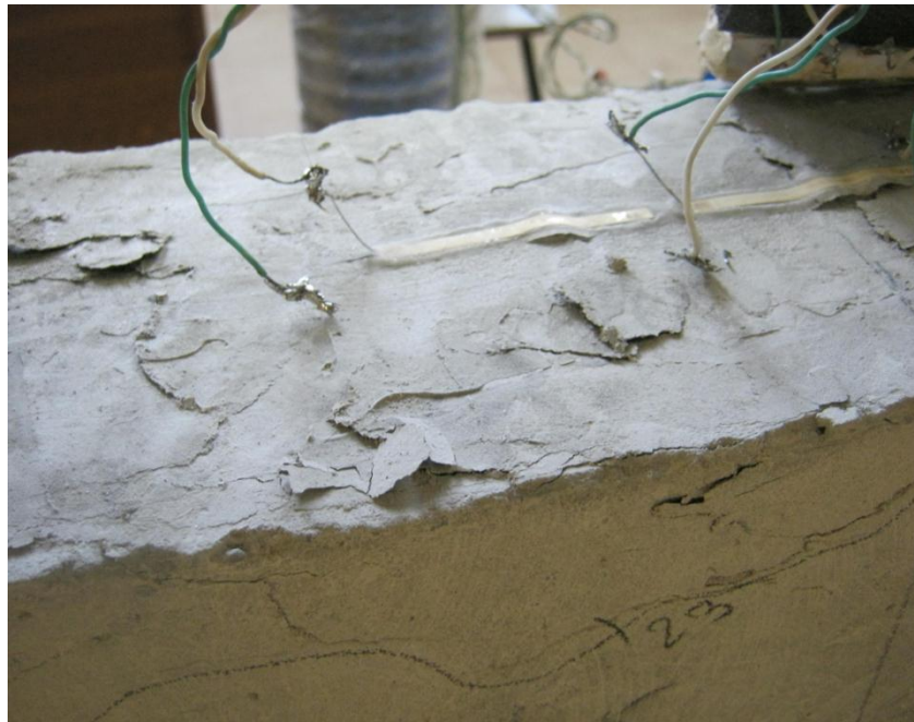
الشكل (26-2) مثال لتحطم البيوتون المضغوط لحظة الانهيار وانسلاخ حساسات التشوه.
