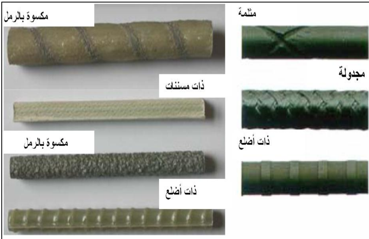
الشكل (1-12) الأشكال المختلفة لقضبان ال FRP واختلاف سطحها الخارجي [3].
