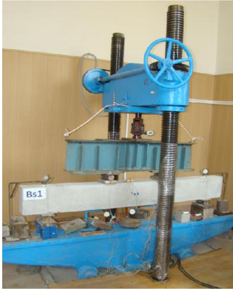
الشكل (15-2) شكل جهاز اختبار الجوائز في مخبر البيتون لدى جامعة روستوف في (روسيا الاتحادية).
