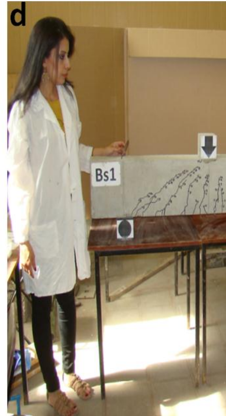
الشكل (2-17) اختبار الجوائز وتسجيل النتائج ، a- وضع الجائز على جهاز الاختبار وتجهيزه بأدوات القياس المختلفة، b- اختبار الجائز وتسجيل مختلف النتائج ، c- تحديد التشققات عند كل مستوى تحميل، d- تصوير العينات بعد الانتهاء من اختبارها.
